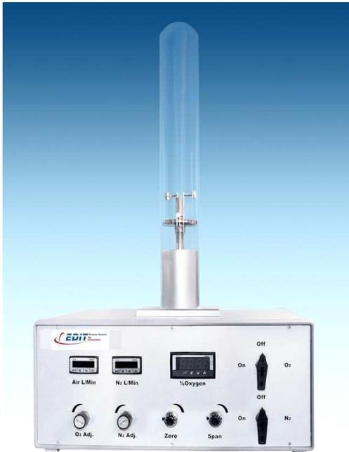
L'appareil d'indice limite d'oxygène (ILO) est utilisé pour déterminer le comportement au feu de matériaux soumis à une petite flamme. C'est le plus essai économique de laboratoire pour quantifier l'allumabilité et la propagation de flamme d'un matériau.
